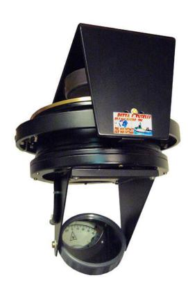
Bussola magnetica a soffitto mod.150/A completa di dispositivi per la compensazione B-C-D (set magneti), approvata MED.
